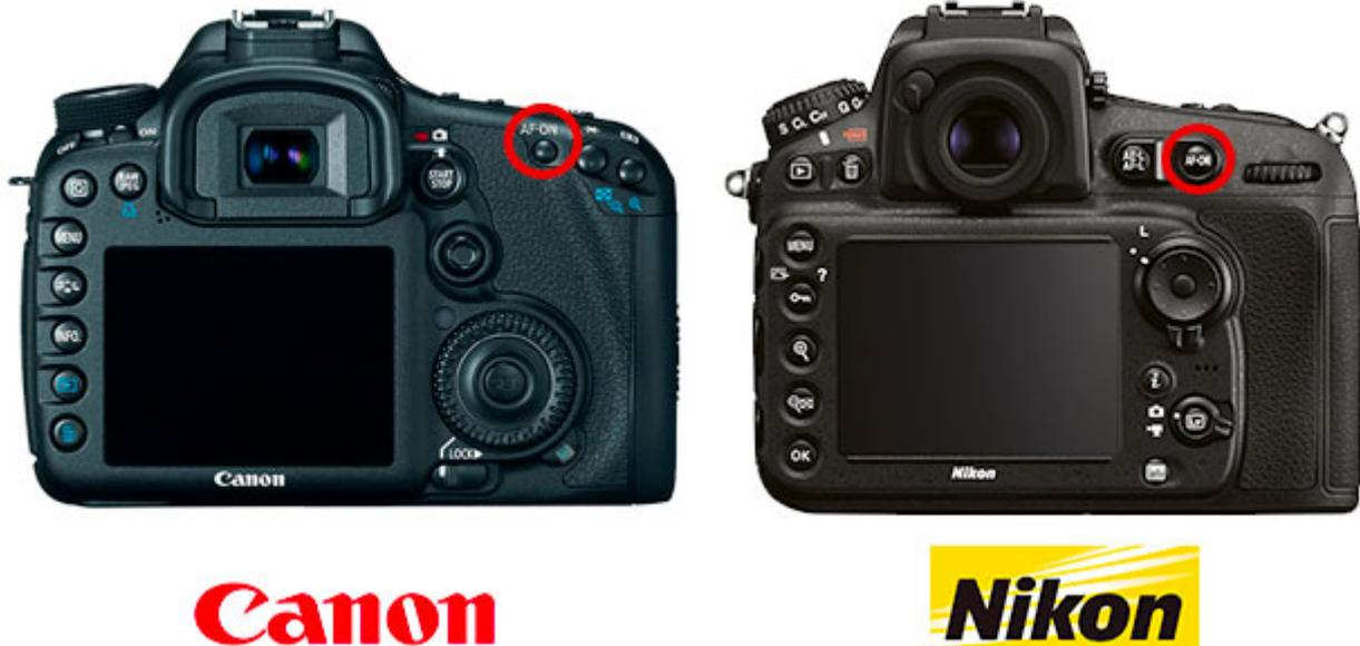
Ce bouton sert uniquement à faire la **mise au point** et dissocie sa fonction du déclencheur. On appelle cela le **découplage de mise au point**.
