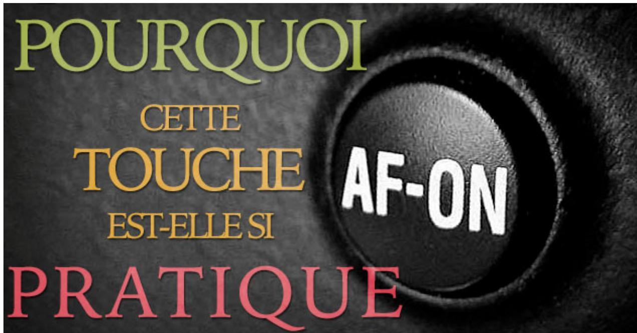
Dans cet article, nous allons voir comment il est possible de s'affranchir de la mise au point classique à mi-course du déclencheur. Situé à l'arrière de votre appareil photo, un petit bouton nommé **AF-ON** pourrait bien vous faciliter la vie pour réaliser la mise au point.
